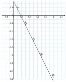
Ces points semblent pouvoir être « approchés » par une droite. Un logiciel propose pour équation  $y'=-2x+\ln(2).$
